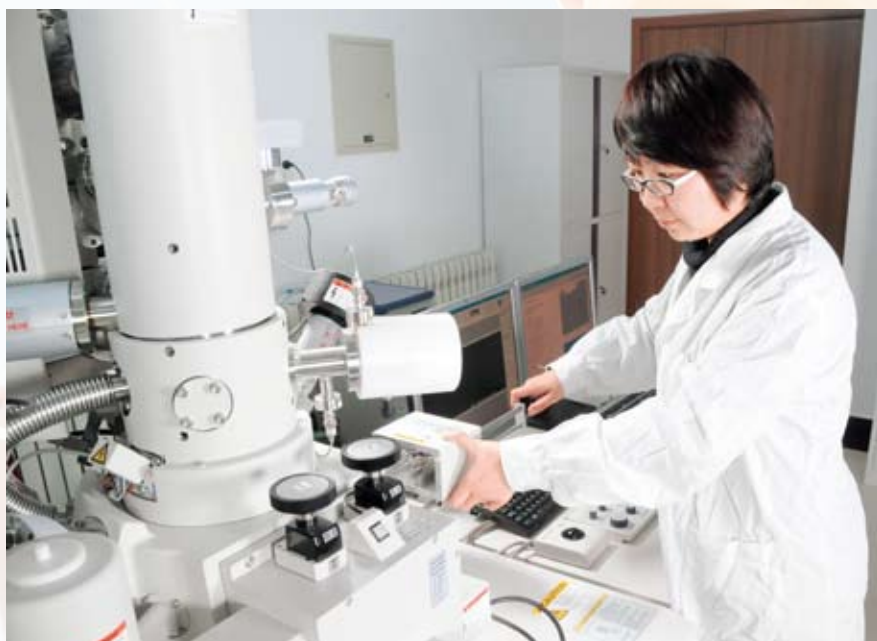
中国建材总院科研人员在绿色建材国家重点实验室操作日立S4800冷场发射扫描电镜
