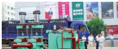
新开发的高压大流量陶瓷柱塞泥浆泵
